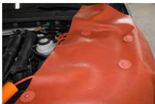
Nappe MP-220 fixée avec les aimants isolés MP-41A704
